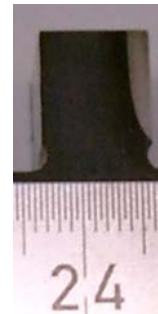
Elektronenstrahl gehärtete Nutflanke (ht bis ca. 2mm)
