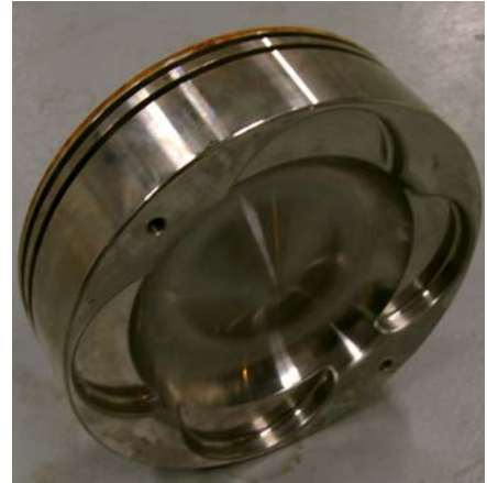
Kolbenoberteil aus 42CrMo4 (Da=320mm)
