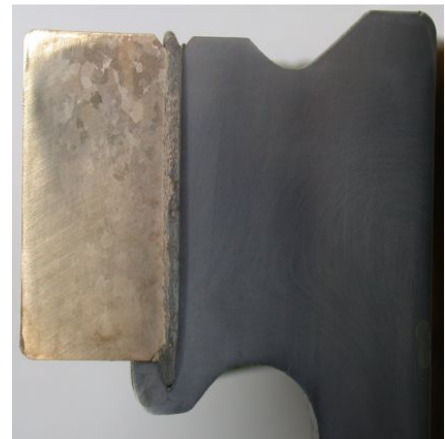
Bronze-Stahl-Verbindung Einschweißtiefe: 25mm
