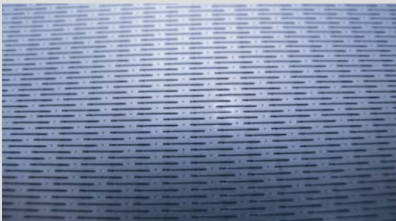
Edelstahl: 0,5 mm Schlitze: 5 mm x 150 µm, offene Fläche: 18%
