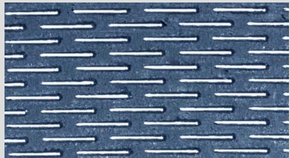
Edelstahl: 3,0 mm Schlitze: 3 mm x 180 µm, offene Fläche: 18%
