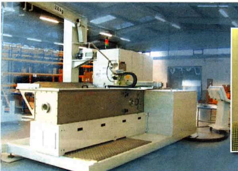
Pro-beam ontwikkelde verschillende lasmachines, ook voor grotere afmetingen. Er is onder meer een 15 meter lange machine die tot 6 meter lange railneuzen last. (foto: Pro-beam)
