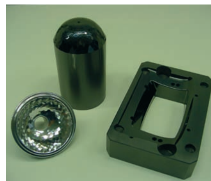
Diadur beschichteter Prägestempel und Ziehring
