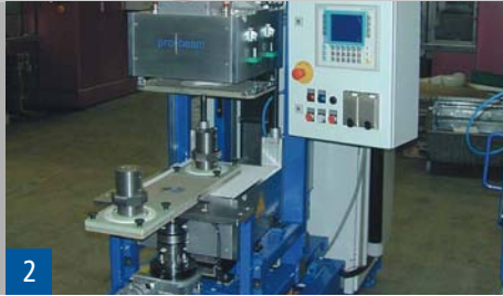
1. Schrumpfpassen von Achse und Zahnrad 2. UMH-Maschine mit drehbarem Werkstücktisch 3. Zahnrad mit Einsteckstück zur Leitung des magnetischen Flusses
