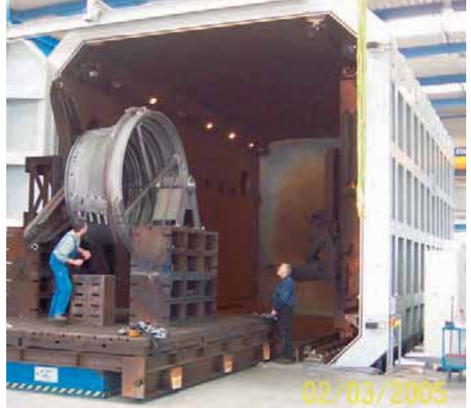
Abb. 18: Einfahren des Leitschaukelträgers in die Anlage
