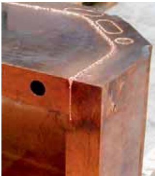
Abb. 14: EB-Schweissung Eckenausbildung und schematische Darstellung
