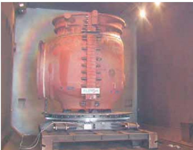
Abb. 20/21: Gasturbinen-Gussgehäuse in der EB-Anlage
