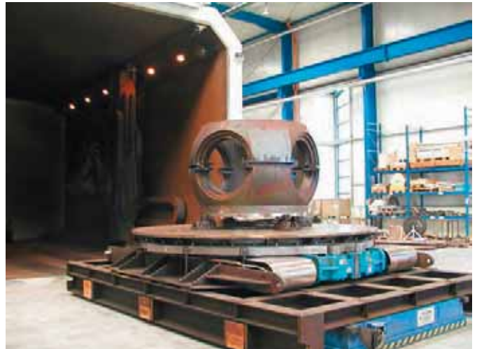
Abb. 10: Zweiteilige Kaplan-Nabe GS20Mn5
