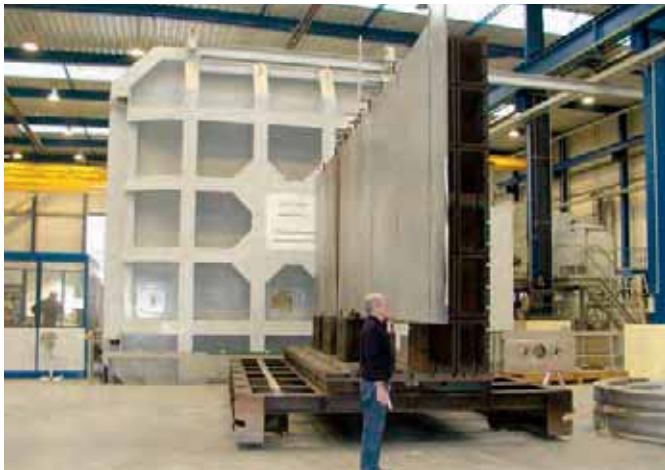
Abb. 3: Gesamtabmessung der 5-teiligen Platte aus Al5083 9,72 x 3 m
