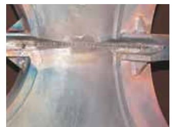
Abb. 12: EB-Wurzel Ausbildung am Stück
