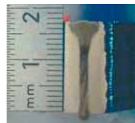
Abb. 7: Rohr aus Nickelbronze Schweißtiefe 22 mm
