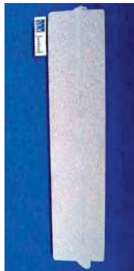
Abb. 6: AlMg4,5Mn0,7 Schweißtiefe 205 mm
