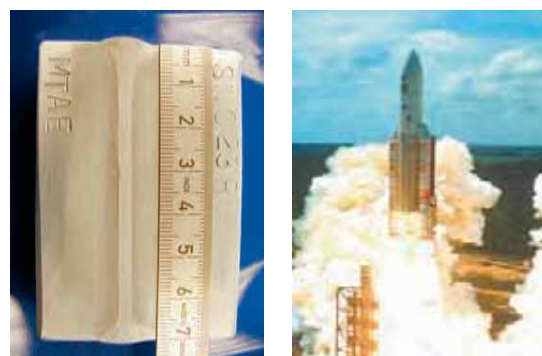
Abb. 2: Elektronenstrahlschweissnaht 70 mm für Dom an ARIANE 5
