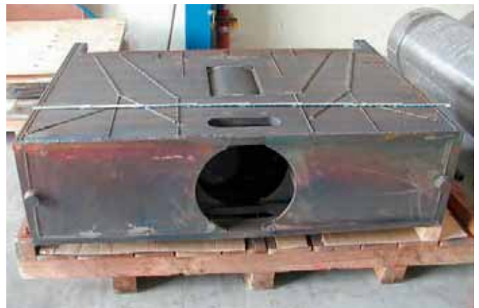
Abb. 15: Stössel für Stanzwerkzeug
