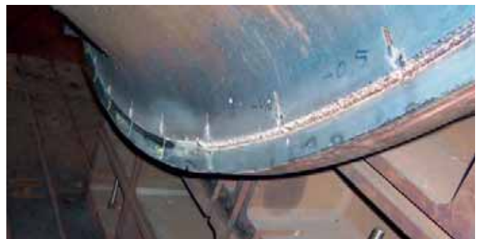
Abb. 19: Nahtwurzel des Leitschaukelträgers mit 60 mm Nahtdicke aus 12CrMo195
