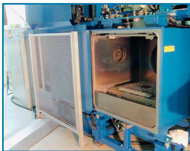
In der Arbeitskammer können Werkstücke auf einem CNC-Tisch in bis zu drei mechanischen Achsen bewegt werden.
