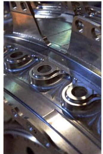
Details des Trent 700-Triebwerks von Rolls-Royce, geschweißt auf einer Universalkammermaschine des Typs K640 Bilder: Pro-Beam
