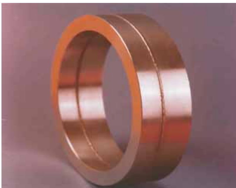
Abb. 63, 64: Schweißnaht in Ring aus SE-Kupfer, 35 mm tief.
