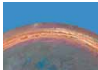
Abb. 65, 66: Kühlkörper mit aufgeschrumpftem Mantel, stirnseitig geschweißt.
