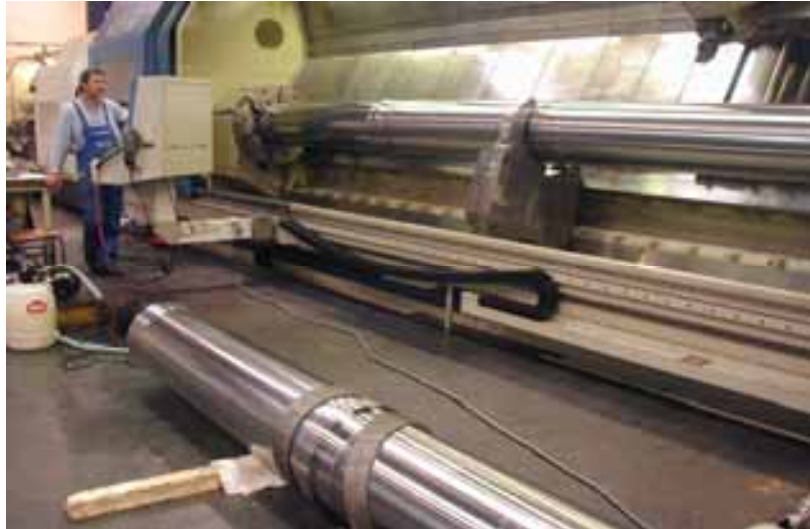
Abb. 240: Lange Kolbenstangen aus kurzen Einzelrohren EB-geschweißt.
