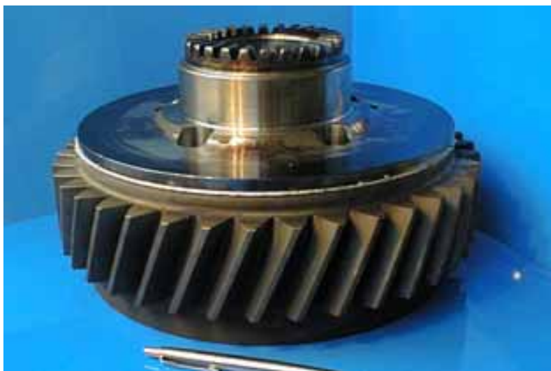
Abb. 155, 156: Planetenträger mit Antriebsrad eines LKW-Getriebes mit radialen EB-Nähten.
