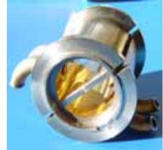
Abb. 133: Infrarot-Küvette. Beim Schweißen darf die Innenvergoldung nicht heiß werden und nicht bedampfen. Dies wurde durch Reduzierung der Wandstärke im Schweißbereich erreicht.
