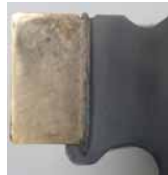
Abb. 188, 189: Bronze mit guten Gleiteigenschaften verbunden mit preiswertem Stahl.
