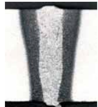
Abb. 22: Schliff 25 Cr Mo 4, 3 mm tief.
