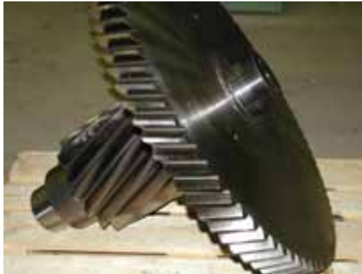
Abb. 160, 161: Das Schweißen von Getrieberädern in allen Größen ist wegen der Ver-zugsarmut weltweit die Hauptanwendung des Elektronenstrahl-Schweißens.
