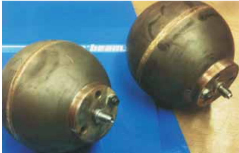
Abb. 77: Kupfer-Absorber eines Solarkraftwerkes. Unter Verwendung von Parabolspiegeln und einer Heat-Pipe wird Heißdampf erzeugt, der eine Dampfturbine antreibt.
