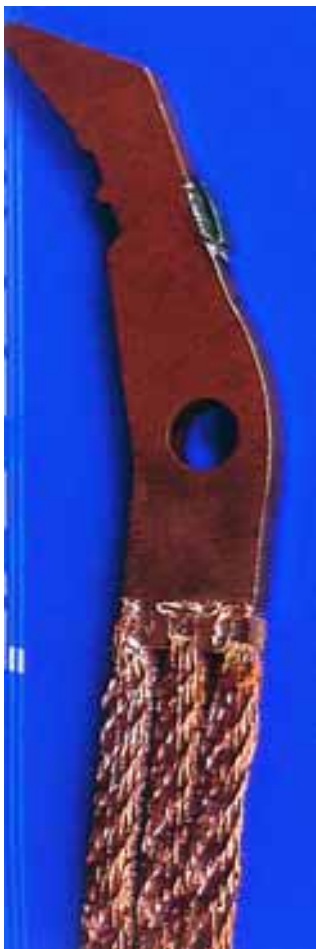
Abb. 141: Kaltverfestigtes Kupfer darf bei 4 Schweißungen seine Härte nicht verlieren.
