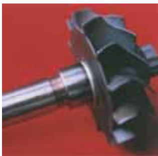
Abb. 106: Turboladerwelle aus Automatenstahl und Schaufelrad aus Inconel.
