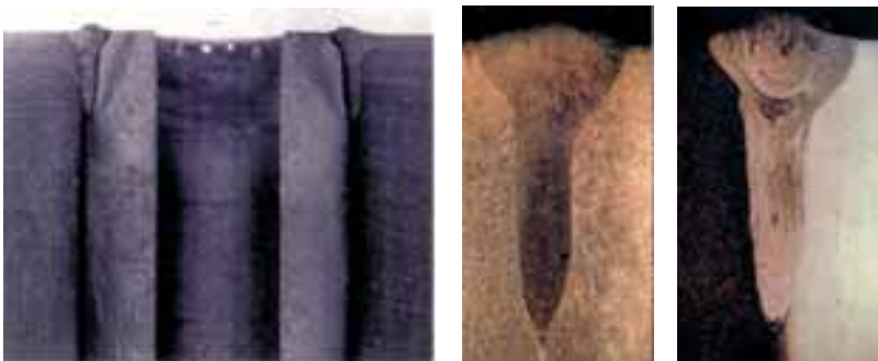
Abb. 83, 84, 85: Schweißsituation (li.), Schliff Inco 718 mit Inco 718 (mi.), Schliff X 5 Cr Ni Nb 18 10 mit Inco 718 (re.).
