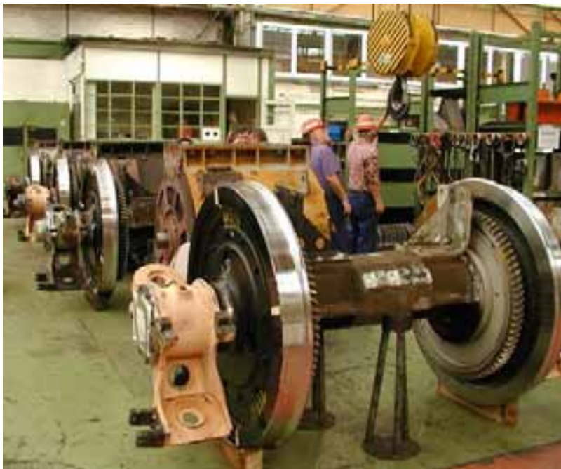
Abb. 263, 264: Montage und Einbausituation der regenerierten Hohlwellenlager.
