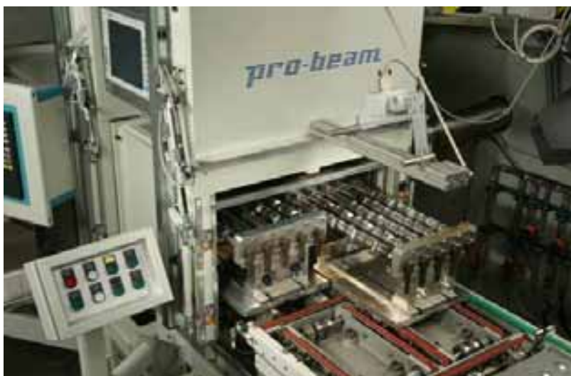
Abb. 278: Automatischer Wechsel der 5-spindligen Drehvorrichtung.
