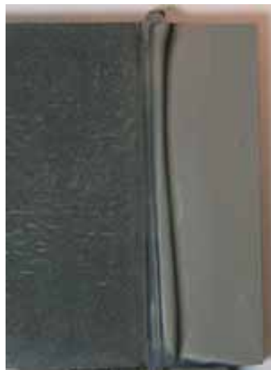
Abb. 102: St 37 mit X 2 Ni Co Mo 18 9 5, 100 mm Schweißtiefe.
