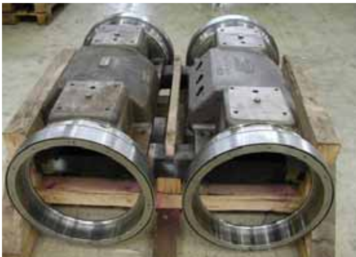
Abb. 259, 260, 261: Reparatur von Hohlwellenlagern von Lokomotiven.
