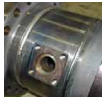
Abb. 238, 239: Hochdruck-Hydraulikzylinder, bis 15.000 kN Druck, Schweißtiefen bis 95 mm.
