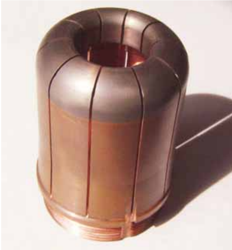
Abb. 194: Materialkombination entsprechend der Beanspruchung eines Hochstromkontaktes aus Wolfram-Kupfer- Legierung und Kupfer.
