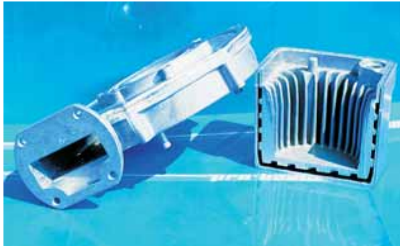
Abb. 49: Pumpengehäuse (Al Si 12) und Wärmeüberträger (Al Si 10 Mg Mn) aus Aluminium-Druckguss, EB-geschweißt.
