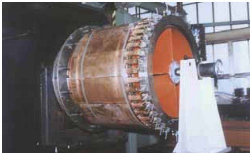
Abb. 243: Kupfertrommel mit Kontaktfahnen aus dem Apparatebau mit 1,6 m Durchmesser.
