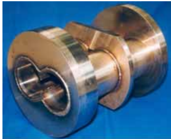
Abb. 168, 169: Gehäuse für Doppelschnecken-Extruder. Es werden sowohl die Längsnähte, als auch die brillenförmigen Axialnähte EB-geschweißt.
