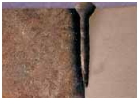
Abb. 114, 115, 116: Selbst Stahl- Stellite (li.) oder Kupfer-Aluminium-Verbindungen (re: Schliff.) sind schweißbar.
