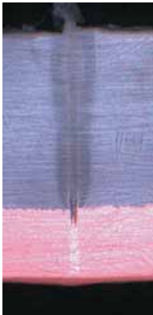
Abb. 119: Stahl- Kupfer Verbund mit Ungängen im Übergangsbereich.
