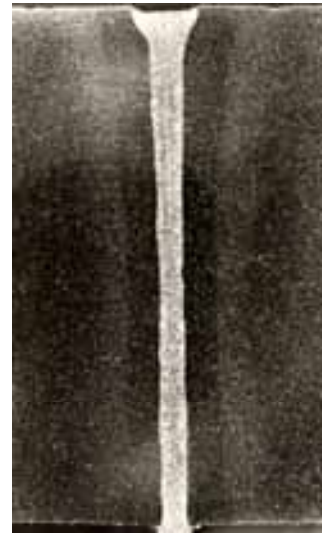
Abb. 27: Tiefschweißung in X 5 Cr Ni 18 9, 1 mm breit, 25 mm tief. Schweißleistung 2,7 kW.
