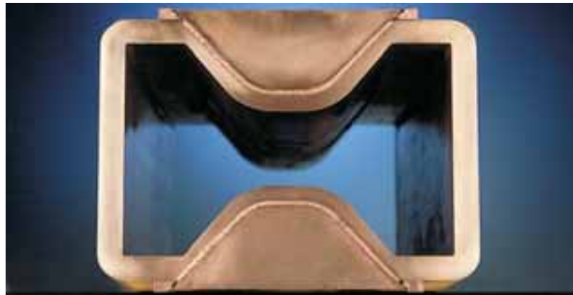
Abb. 68: Eingusskokillen für die Stahlindustrie aus Cu Cr Zr, Schweißtiefe: 40 mm.
