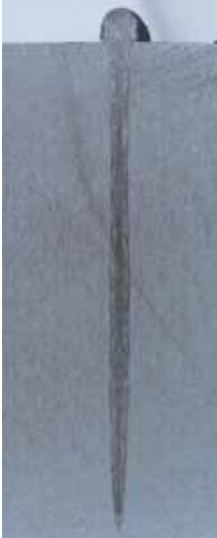
Abb. 32: Schlanke, 45 mm tiefe Naht in austenitischem Stahl.
