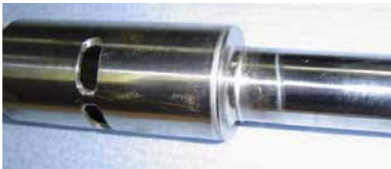
Abb. 163: Kolbenstange aus 2 Rohren und einer Scheibe mit 2 EB-Nähten gefertigt.
