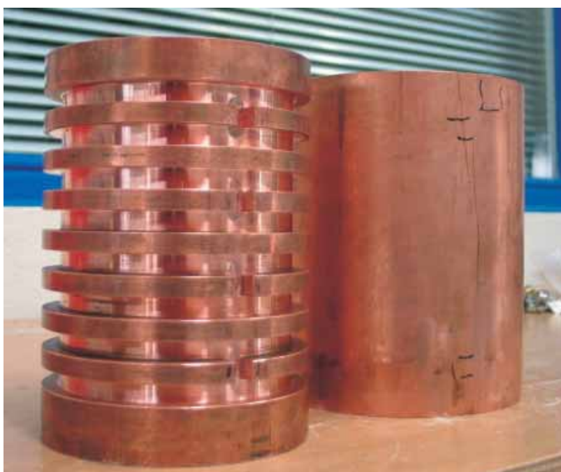
Abb. 65, 66: Kühlkörper mit aufgeschrumpftem Mantel, stirnseitig geschweißt.
