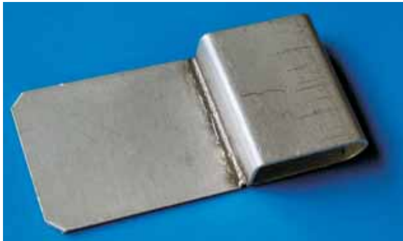
Abb. 56: Feinschweißung in 0,7 mm dickem Alu- blech.
