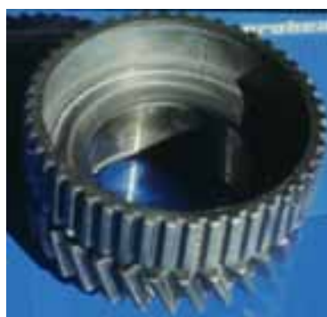
Abb. 195, 196: Zahn- radkombinationen mit schwer zugänglichen Schweißpositionen.
