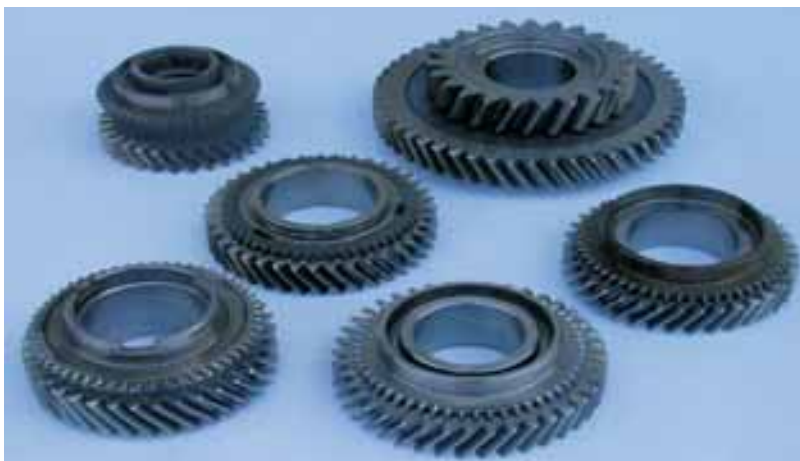
Abb. 19: 16 Mn Cr 5 ist der am häufigsten verwendete Werkstoff für Zahnradkombinationen in Schaltgetrieben.
