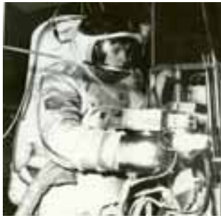
Abb. 1: Mit der kleinen handgeführten EB-Kanone wurden unter Weltraumbedingungen Reparaturschweißungen an der Raumstation MIR ausgeführt.
