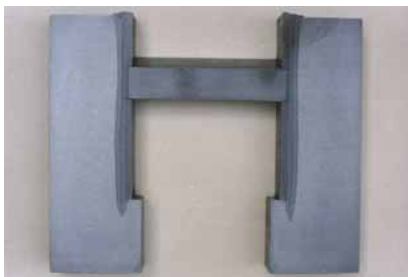
Abb. 190, 191: Schnitt durch einen Dampfturbinen-Stator mit 80 bis 140 mm tiefen Schweißnähten bei 5 bis 8 mm Wanddicke der Plattierung.
