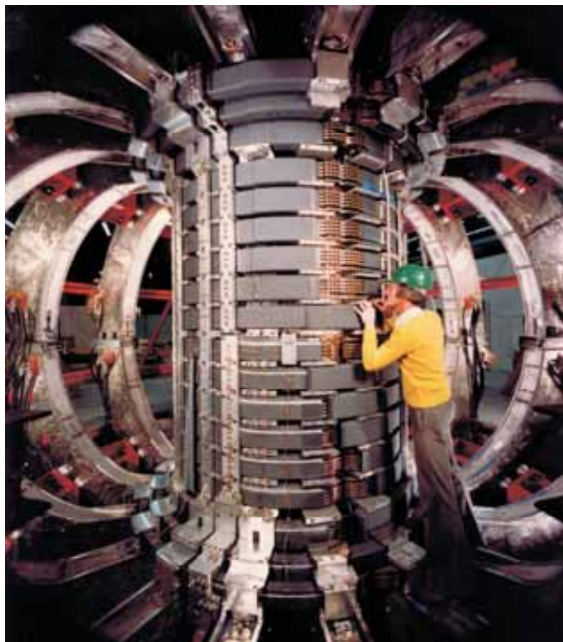
Abb. 69, 70: Über tausend EB- geschweißte Spann- bügel aus Cu Be 2 befinden sich im Asdex Fusionsreaktor.
