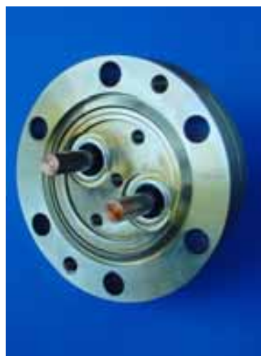
Abb. 142, 143: Damit wegen der unterschiedlichen Wärmeausdehnungen zwischen Isolator und Metall keine Risse entstehen, muss mit geringster möglicher Wärmeeinbringung geschweißt werden.
