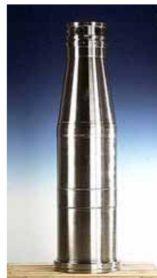
Abb. 30: Dekanter aus Duplexstahl, 2,8m hoch, X 2 Cr Ni Mo N 22 5, Schweißtiefe 20 mm.
