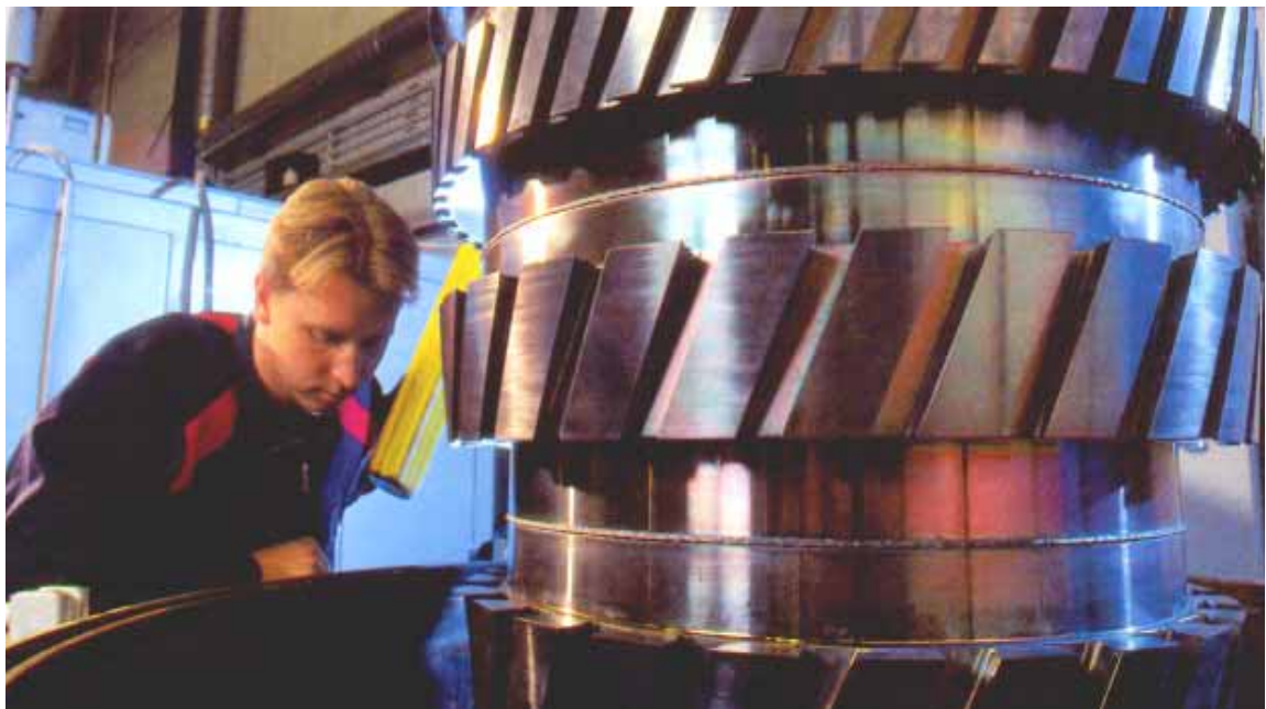
Abb. 237: Welle einer Kraftwerksturbine. Die Einzelsegmente können auf kleineren Maschinen bearbeitet werden.
