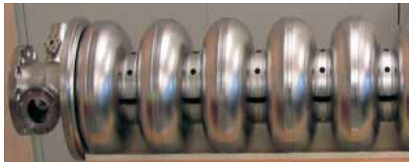
Abb. 88: Supraleitende Kavität eines Teilchenbeschleunigers aus Niob mit bis zu 50 EB-Nähten.
