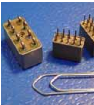
Abb. 232: Relaisgehäuse mit temperaturempfindlichen Glasdurchführungen.
