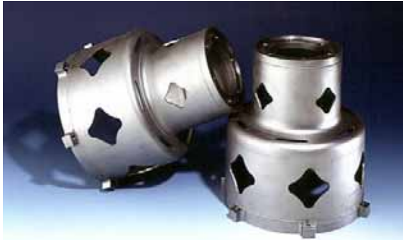
Abb. 166: Hohlwelle aus zwei lasergeschnittenen Umformteilen und 2 Endflanschen mit zwei radialen und einer axialen EB-Naht gefügt.
