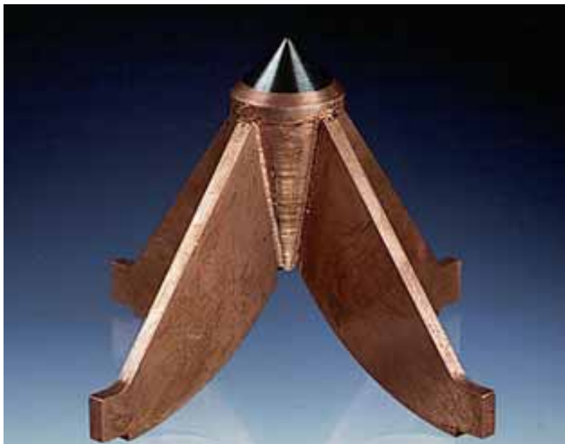
Abb. 170: Hochstrom-Katode aus Wolframspitze mit Kupfer vergossen, daran 4 gestanzte FüÙe aus Kupferblech geschweiÙt.
