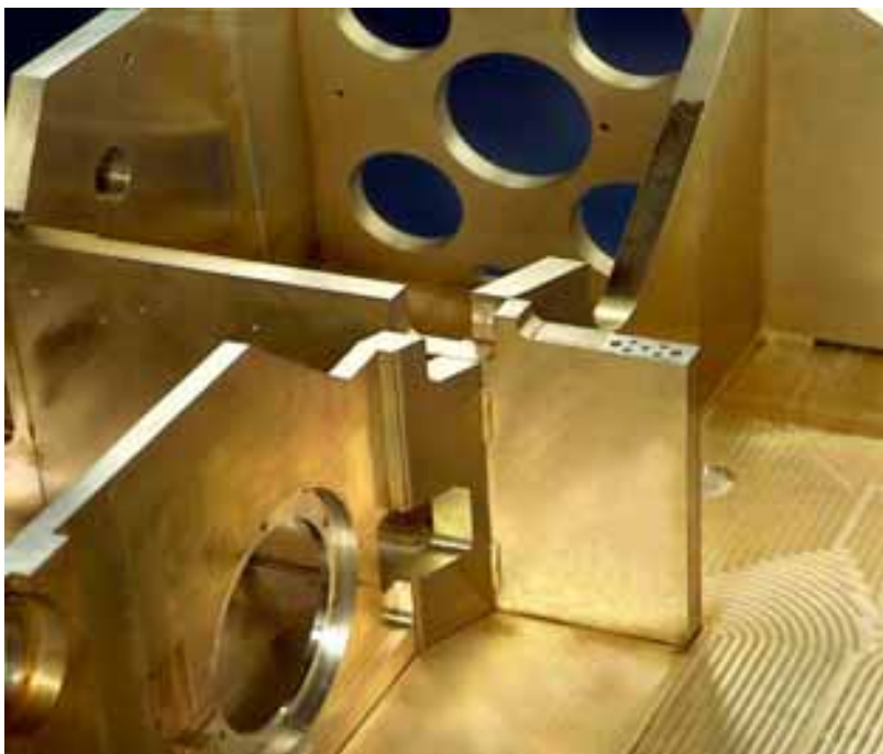
Abb. 164: Mikroskop-Gehäuse aus Aluminium-Platten präzisionsgeschweißt, statt aus dem Vollen gefräst.
