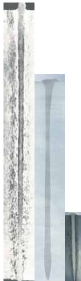
Abb. 47: In Aluminium lassen sich besonders schlanke Schweißnähte erzielen, hier z.B.: 200 mm, 150 mm bzw. 50 mm tief.
