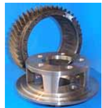
Abb. 155, 156: Planetenträger mit Antriebsrad eines LKW-Getriebes mit radialen EB-Nähten.
