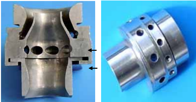
Abb. 180, 181: Mischkopf, der zerspanend so nicht herstellbar ist. Zwei Radialnähte machen es möglich.
