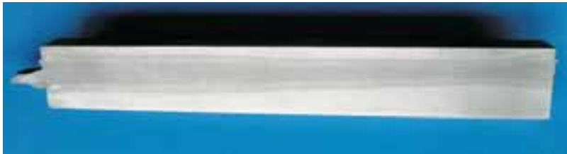
Abb. 10: Schliff einer 200 mm tiefen Naht in St 52.3 horizontal geschweißt mit Badunterstützung.
