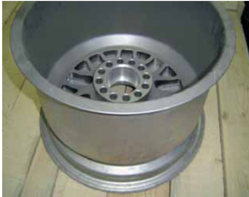
Abb. 62: Rennfelge aus AZ 80, stirnseitig geschweißt.
