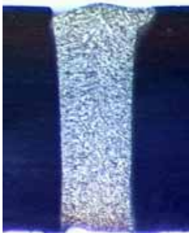
Abb. 29: Rohrlängsnaht in Duplexstahl, 7 mm breit, 22 mm tief, Schweißleistung 15 kW.
