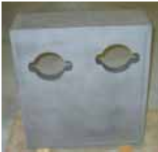
Abb. 15: Schweißkonstruktion eines Maschinen- Gestells aus St 52.3 als Ersatz für Gussteil.
