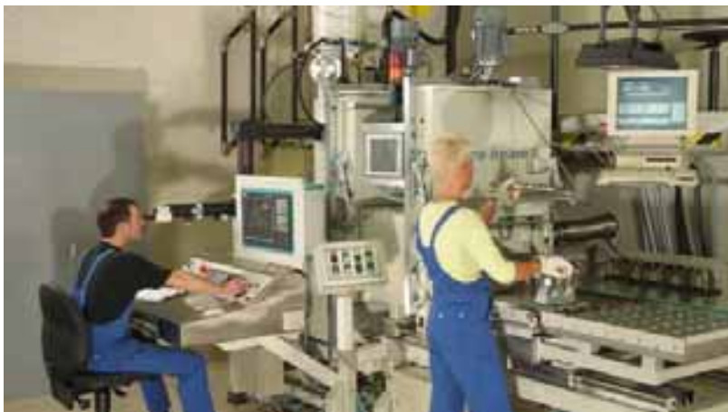
Abb. 277: Bestücken und Schweißen auf einer Schleusen-Shuttle-Anlage.
