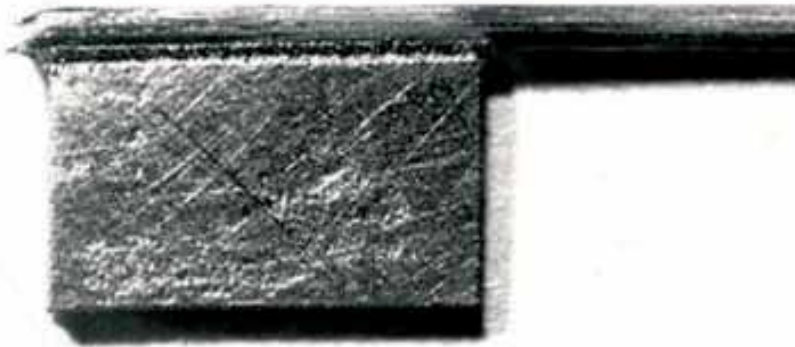
Abb. 98: Fahne aus Wolfram, Drahtdurchmesser und Fahne 0,5 mm, gepulst geschweißt
