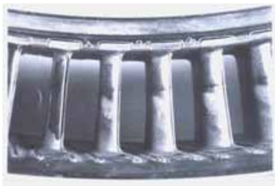
Abb. 269 bis 272: Spannvorrichtung, Schaufelmontage mit Hilfswerkzeug, Entfernen des Spannringes und Detail der Schaufelschweißung.
