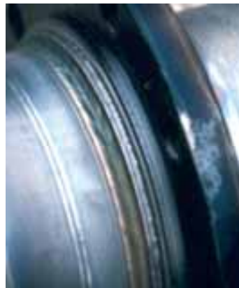
Abb. 145, 146: Beispiele für große Wärme einbringung: Links: Rohrschweißung mit Deck- und Wurzellage aus Gründen des Korrosionsschutzes und der Regelwerke. Rechts: Hinterachsstummel mit angeschweißtem Bremsflansch mit 3 nebeneinander liegenden Nähten zur Vergrößerung des tragenden Querschnittes.
