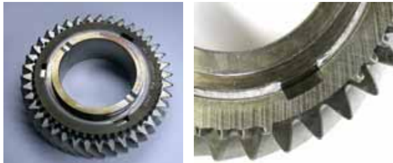
Abb. 158, 159: Schalt- rad in 3-Strahl-Technik EB-geschweißt.
