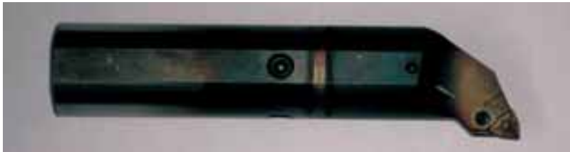
Abb. 18: Standardwerkzeug mit Verlängerungs-Bohrstange aus 16 Mn Cr 5, Schweißtiefe 20 mm.
