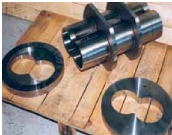
Abb. 168, 169: Gehäuse für Doppelschnecken-Extruder. Es werden sowohl die Längsnähte, als auch die brillenförmigen Axialnähte EB-geschweißt.
