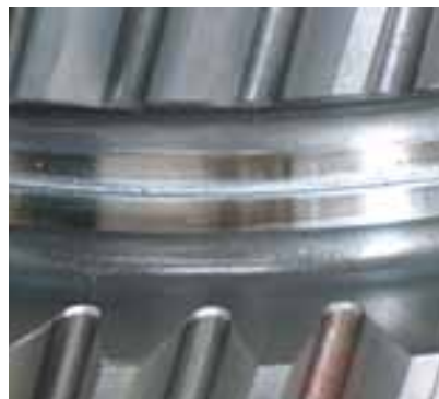
Abb. 20, 21: Doppelzahnrad aus 17 Cr Ni Mo 6, Einschweißtiefe 9 mm.
