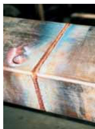
Abb. 76: Detail zu Abb. 75, eckige „Rundnaht“ 15 bis 40 mm Schweißtiefe, CNC-gesteuert.
