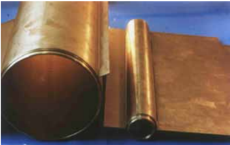
Abb. 154: Schäumformen zur Herstellung von Styropor-Rohrisolierungen. Sowohl Rundheit wie Winkelverzug der Stegbleche werden genau eingehalten.
