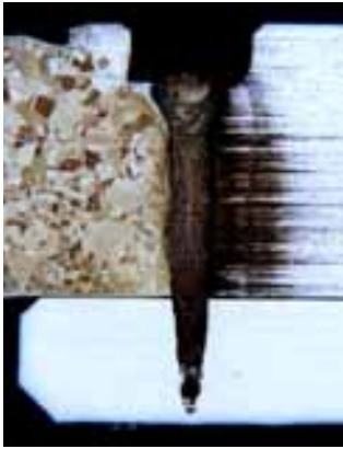
Abb. 229: 0,2 mm breite Sensornäht.
