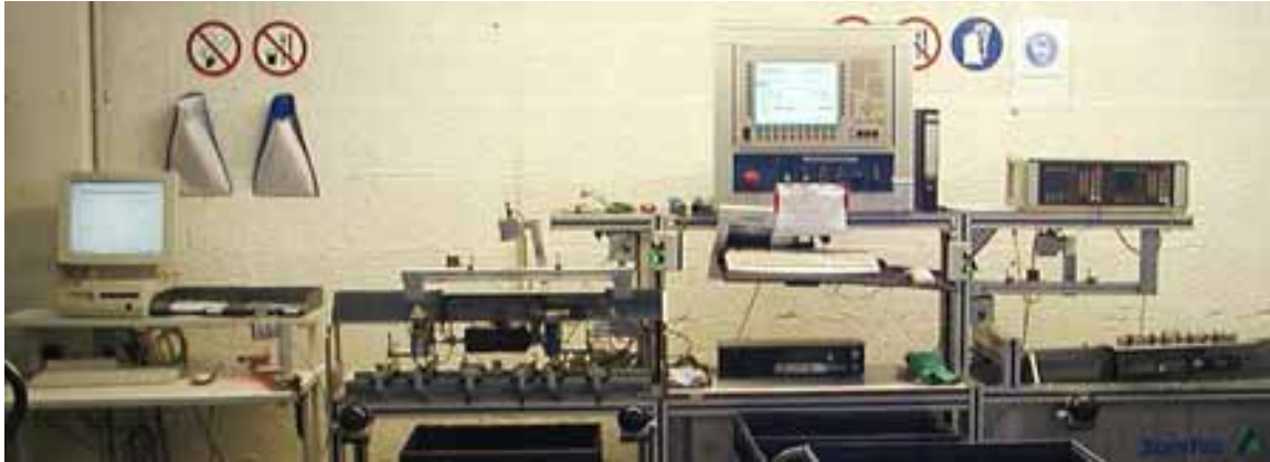
Abb. 281: Prüfung auf Rundlaufgenauigkeit nach dem Schweißen und Dokumentation.
