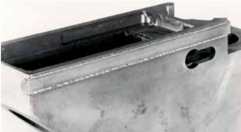
Abb. 111: Schiene aus Einsatzstahl mit einer Nickel-Zwischenlage an Gusseisen geschweißt.
