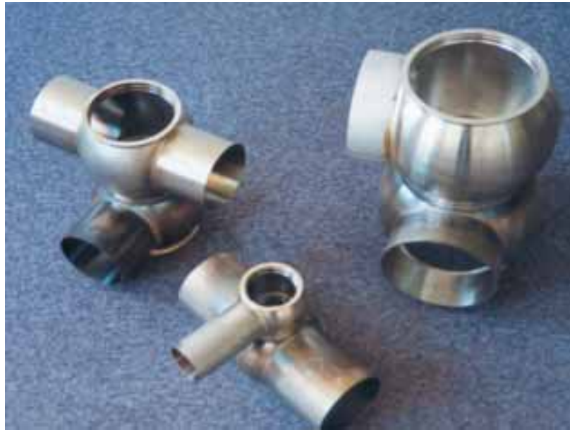
Abb. 31: Ventilkombinationen aus der Getränkeindustrie. Aus Hygienegründen sind korrosionsbeständige, glatte Nähte ohne Restspalte gefordert.
