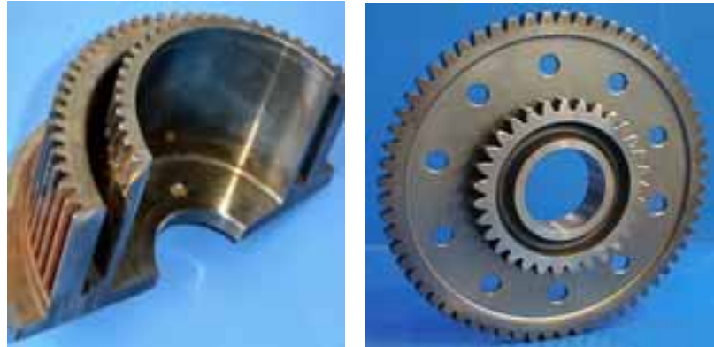
Abb. 176: Aus zwei dünnen Scheiben gefertigte Zahnradkombination.
