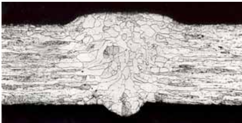
Abb. 26: Feinschweißung in Blech aus X 22 Cr Ni 17, 0,5 mm dick. Schweißleistung 0,1 kW.
