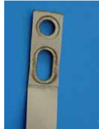
Abb. 224: 30 \mu\text{m} dickes Spannband mit 70 \mu\text{m} dickem Endstück verbunden.
