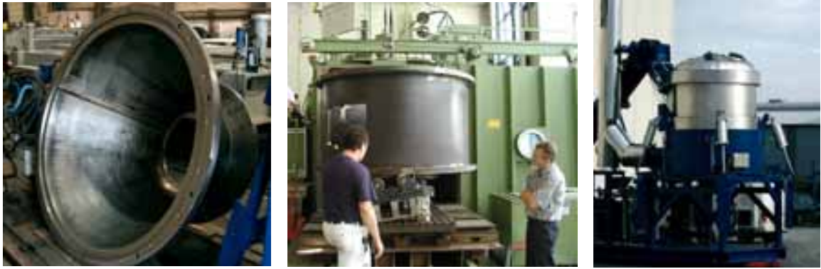
Abb. 244, 245, 246: Teile eines Ofens zum Sprengen von Alt-Munition, geschweißt in einer EB- Vakuumkammer mit 20 m 3 .
