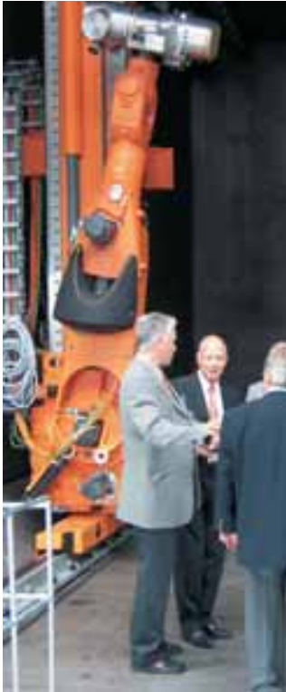
Abb. 8: Mobile Strahlkanone am 3-Meter Roboterarm mit Verfahrweg 12 x 7 m.
