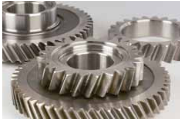
Abb. 160, 161: Das Schweißen von Getrieberädern in allen Größen ist wegen der Ver-zugsarmut weltweit die Hauptanwendung des Elektronenstrahl-Schweißens.
