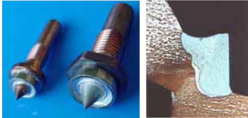
Abb. 127, 128: Lötverbindung Kupfer – Titan mit Silberlot.
