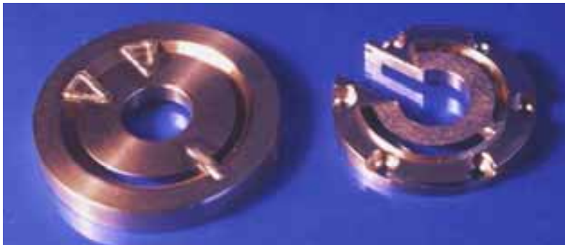
Abb. 167: Kompliziertes Bauteil aus Innenring, Außenring und 2 Segmenten, alle als Drehteile gefertigt, mit 3 EB-Nähten gefügt. Links: Halbzeug, Rechts: fertig bearbeitet.
