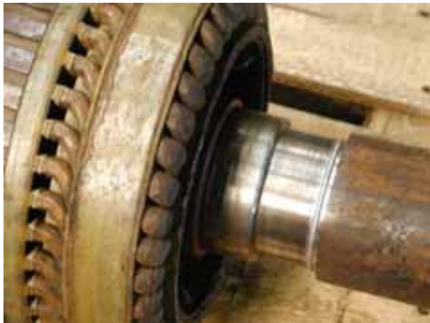
Abb. 251, 252: Verschlissenes Ventilgehäuse aus 42 Cr Mo 4 wurde durch Einsetzen einer neuen Buchse instand gesetzt. Schweißtiefe: 55 mm.
