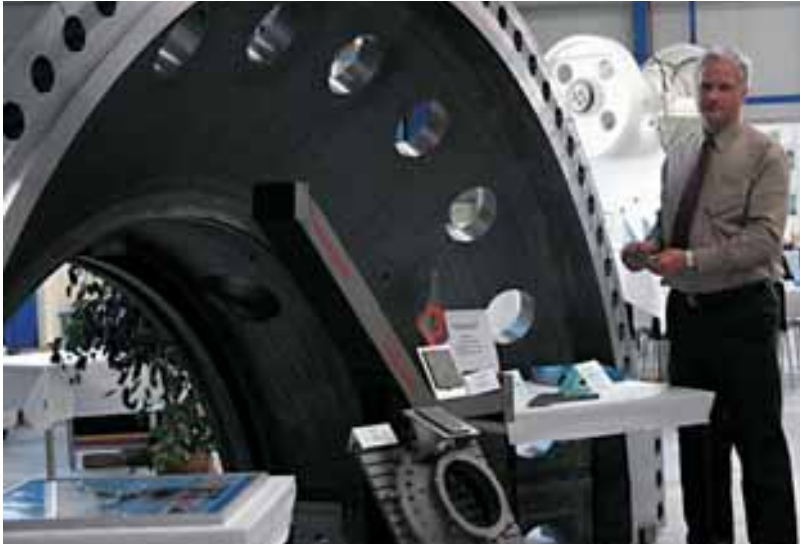
Abb. 12: Turbinengehäuse aus warmfestem Stahlguss GS-15 Mo 3.
