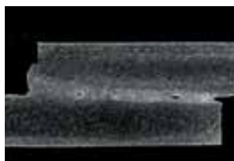
Abb. 59, 60: Die gute Schweißbarkeit von DG-AM 50 erlaubt interessante konstruktive Möglichkeiten (Schweißtiefe: 20 mm).
