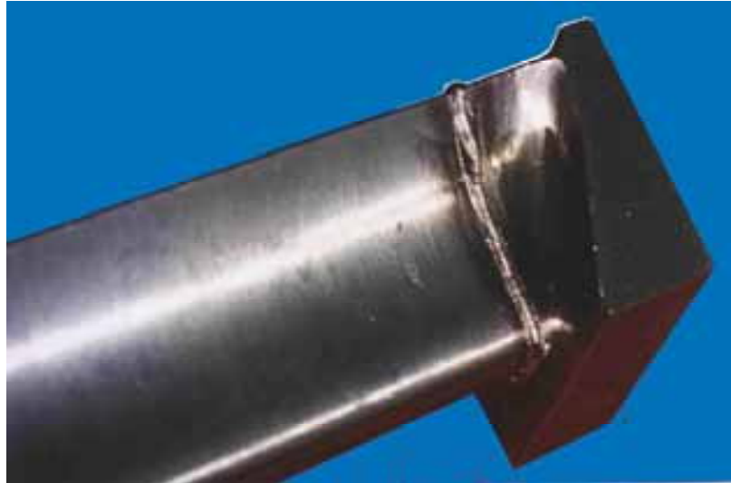
Abb. 192: 3D-Schweißung einer Dampfturbinen- schaufel mit Fokus, Strom und Geschwin- digkeitssteuerung.
