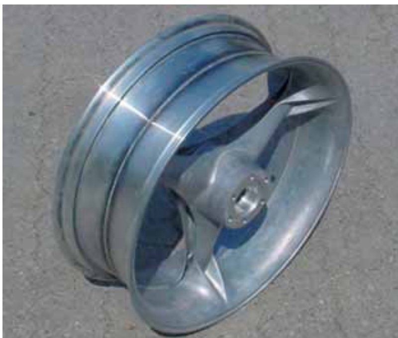
Abb. 53: Motorradfelge aus Aluminium-Druckguss mit Schliff, auf dem die Kosmetik-Decklage erkennbar ist.
