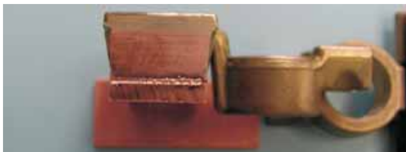
Abb. 80: Messingklemme mit Löt- und Schweißverbindung an Kupfer.
