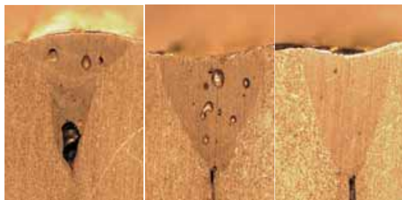
Abb. 50: Durch 2 bzw. 3 hintereinander laufende Schweißstrahlen lässt sich in G-Al-Werkstoffen, die Porenbildung unterdrücken.
