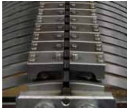
Abb. 151, 152, 153: Genau auf Maß geschliffene Messbänder. Zur Einhaltung der Maßgenauigkeit wird von 2 Seiten geschweißt, die Messfläche bleibt ungeschweißt.
