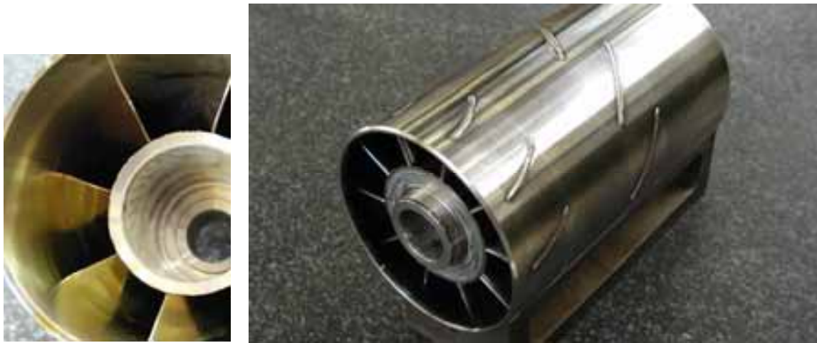
Abb. 206, 207: Das Schweißen mittels Stichnähten eröffnet eine Vielfalt von konstruktiven Möglichkeiten.
