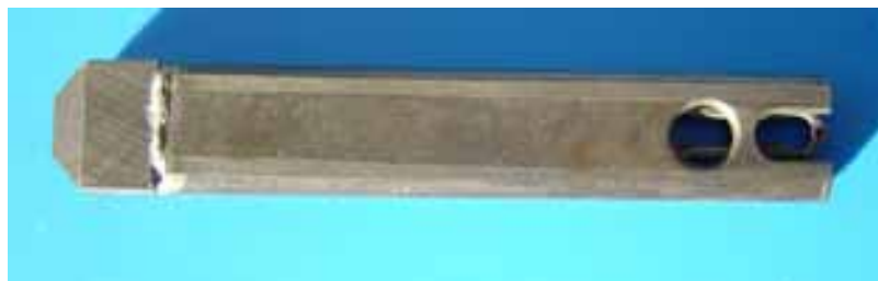
Abb. 187: Webschiffchen mit innenliegender Greifzange.
