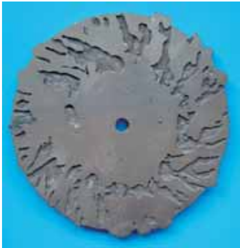
Abb. 40: Schlauchporen beim Schweißen von GGG-60.
