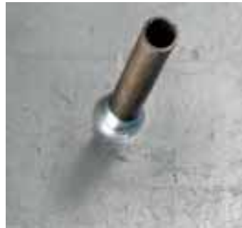
Abb. 114, 115, 116: Selbst Stahl- Stellite (li.) oder Kupfer-Aluminium-Verbindungen (re: Schliff.) sind schweißbar.
