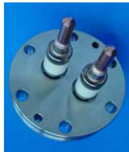
Abb. 142, 143: Damit wegen der unterschiedlichen Wärmeausdehnungen zwischen Isolator und Metall keine Risse entstehen, muss mit geringster möglicher Wärmeeinbringung geschweißt werden.
