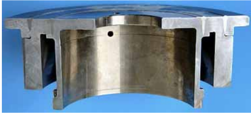
Abb. 174: Aus 2 Zylindern und einem Ring zusammengesetzte Baugruppe.
