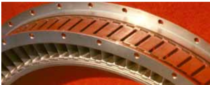
Abb. 268: Fertiger Leitkranz mit angeschweißten Schulterringen.
