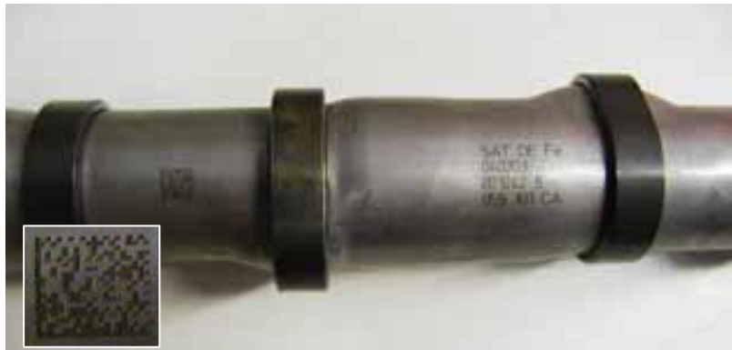
Abb. 274: Mit Data-Matrix-Code und Klartext gekenn- zeichnete Nockenwel- len werden angeliefert.
