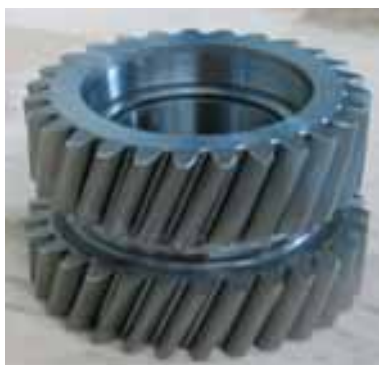
Abb. 20, 21: Doppelzahnrad aus 17 Cr Ni Mo 6, Einschweißtiefe 9 mm.
