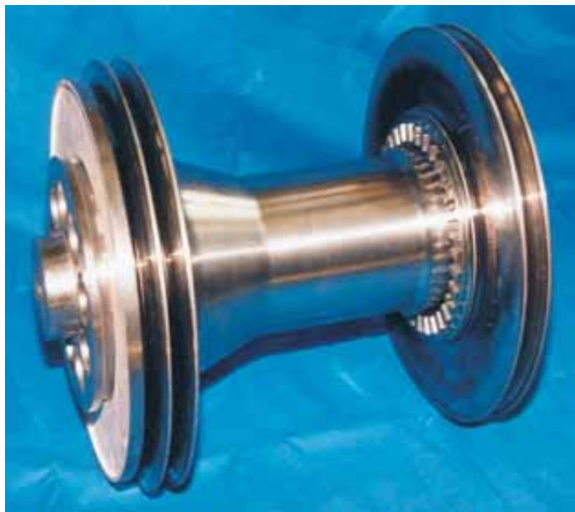
Abb. 24: Torsionssteife, biegeeweiche Kupplungswelle aus 31 Cr Mo V 9 oder 30 Cr Ni Mo 8.
