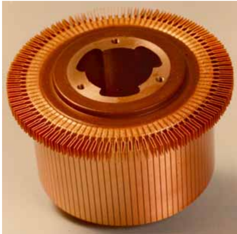
Abb. 140: 8 mm tiefe, gepulste Schweißnähte fügen Kollektorfahnen dicht neben Isolationsmaterial.
