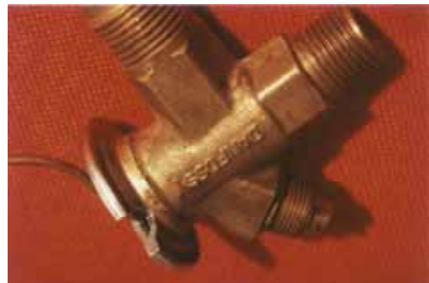
Abb. 212, 213, 214, 215: Das Verschweißen von dünnen Membranen für unterschiedliche Anwendungen ist mit dem Elektronenstrahl möglich.
