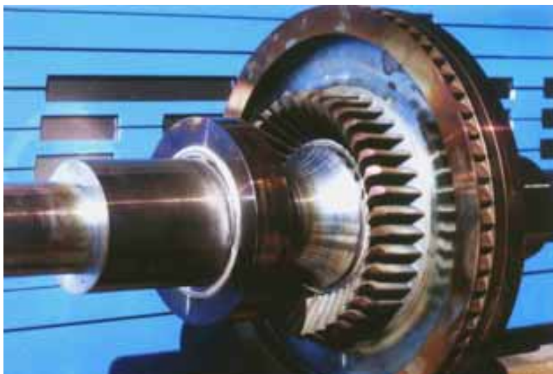
Abb. 255: Verschlissene Teile eines Turbinenrades wurden durch Neuteile ersetzt.
