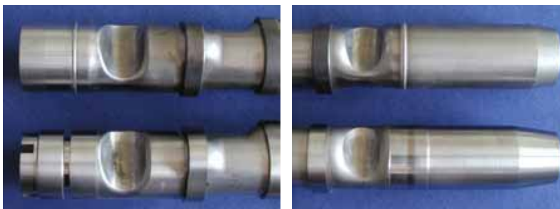
Abb. 279, 280: Nockenwellen nach dem Schweißen (jeweils oben) und nach der Fertigbearbeitung (jeweils unten).
