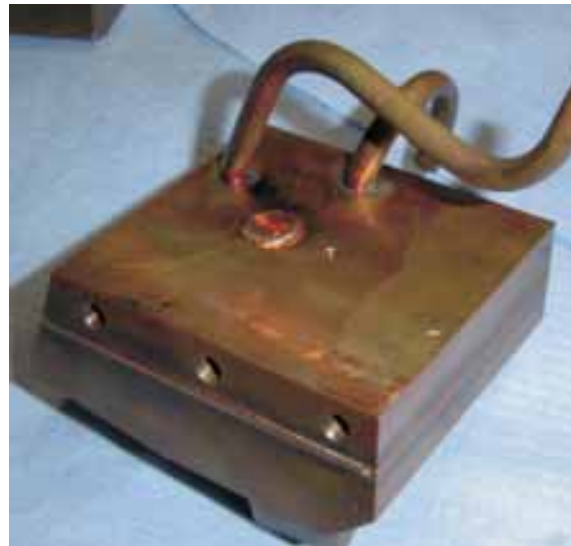
Abb. 78, 79: Kühlkörper für experimentelle Forschungsanlagen.
