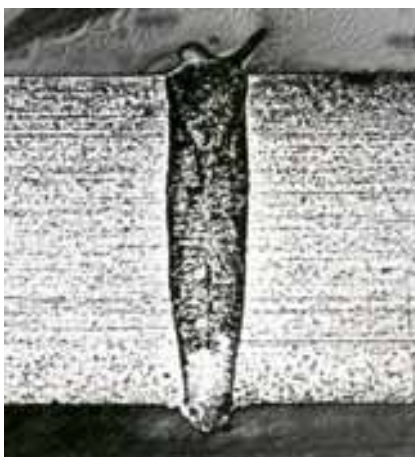
Abb. 28: Schweißnaht in X 6 Cr Ni Ti 18 10, 3 mm tief, Schweißleistung 1,1 kW.
