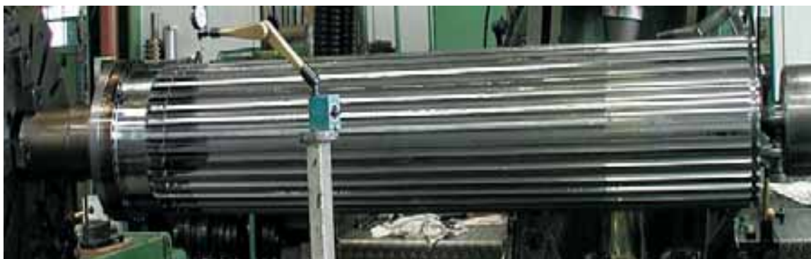
Abb. 25: Verlängerung eines Zahnrohres aus 42 Cr Mo 4 V um 250 mm, Schweißtiefe 20 mm, als Änderung eines angearbeiteten Bauteils.
