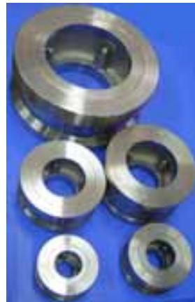
Abb. 182, 183: Familien von CrNi-Stahlarmaturen als Feinguss mit eingeschweißtem Ring ist wirtschaftlicher als das Gießen mit verlorenem Kern.
