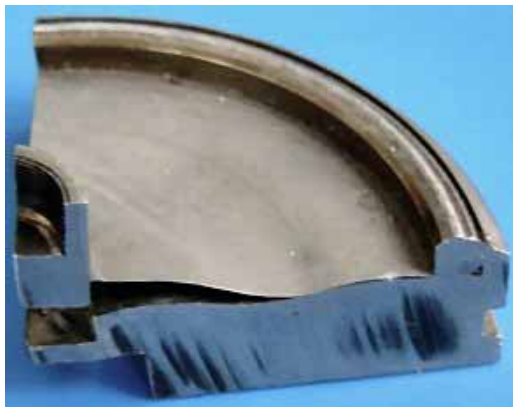
Abb. 212, 213, 214, 215: Das Verschweißen von dünnen Membranen für unterschiedliche Anwendungen ist mit dem Elektronenstrahl möglich.
