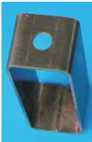
Abb. 69, 70: Über tausend EB- geschweißte Spann- bügel aus Cu Be 2 befinden sich im Asdex Fusionsreaktor.
