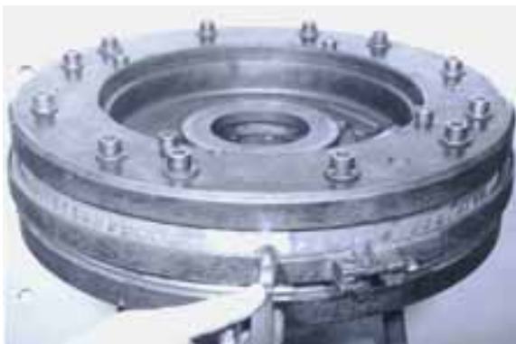
Abb. 269 bis 272: Spannvorrichtung, Schaufelmontage mit Hilfswerkzeug, Entfernen des Spannringes und Detail der Schaufelschweißung.
