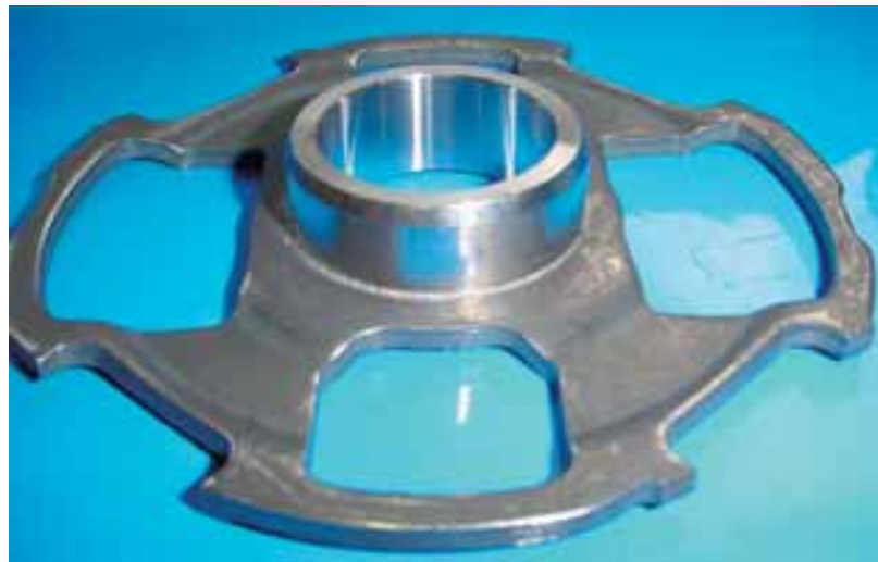
Abb. 17: Vergütetes Blech und Nabe aus Ck 35.
