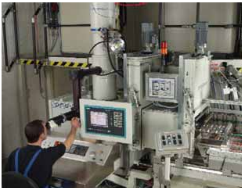
Abb. 7: Schleusen-Shuttle Anlage mit 0,6 m 3 Kammer-volumen. Über die geöffnete Schleuse (re.) findet der automatische, schnelle Teilewechsel statt.
