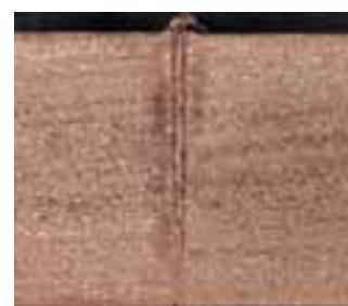
Abb. 63, 64: Schweißnaht in Ring aus SE-Kupfer, 35 mm tief.
