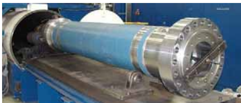
Abb. 238, 239: Hochdruck-Hydraulikzylinder, bis 15.000 kN Druck, Schweißtiefen bis 95 mm.
