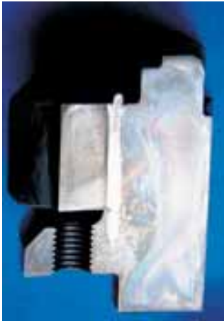
Abb. 23: Zahnkörper aus 21 Ni Cr Mo 2.
