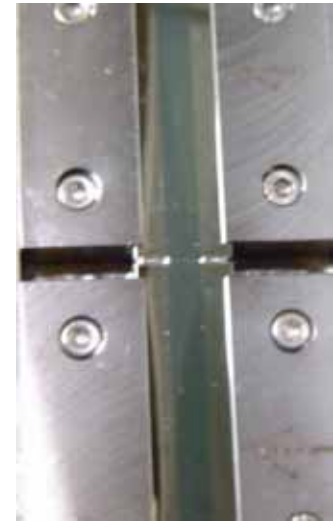
Abb. 151, 152, 153: Genau auf Maß geschliffene Messbänder. Zur Einhaltung der Maßgenauigkeit wird von 2 Seiten geschweißt, die Messfläche bleibt ungeschweißt.
