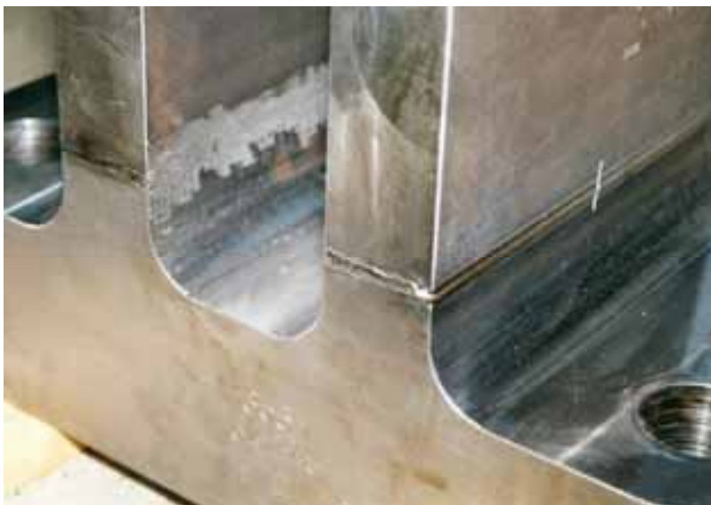
Abb. 249: Naht an der Lasche, rechts wie geschweißt, links zusätzlich verschliffen zur Röntgenprüfung.
