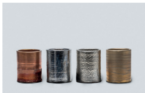
BAUTEIL: Zylinder WERKSTOFF: Kupfer, Titan, Edelstahl, Kupferlegierung / as-built AUSSENDURCHMESSER: 105 mm
