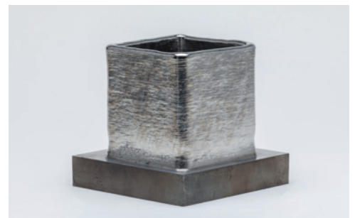
BAUTEIL: Quadratisches Rohr WERKSTOFF: Titan / as-built KANTENLÄNGE: 110 mm BAURATE: 0,8 - 1,6 kg/h
