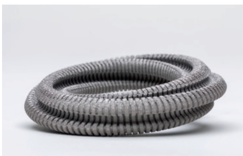
BAUTEIL: Geometrie-Modell WERKSTOFF: Titan / as-built
