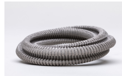
BAUTEIL: Geometrie-Modell WERKSTOFF: Titan / as-built
