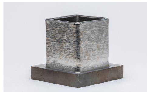
BAUTEIL: Quadratisches Rohr WERKSTOFF: Titan / as-built KANTENLÄNGE: 110 mm BAURATE: 0,8 - 1,6 kg/h
