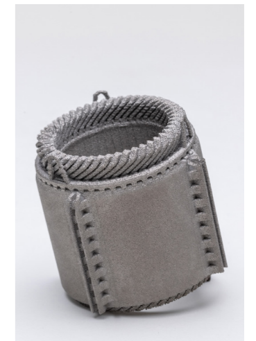
BAUTEIL: Elektromotorkomponente (Modell) WERKSTOFF: Titan / as-built
