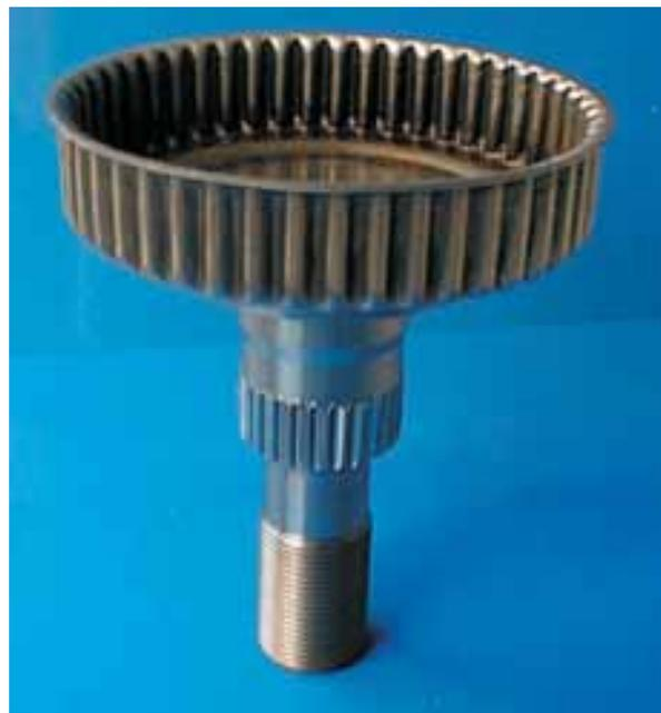
*Abb. 116: Tiefgezogenes Blechteil mit Hohlwelle einer Kupplung.*
