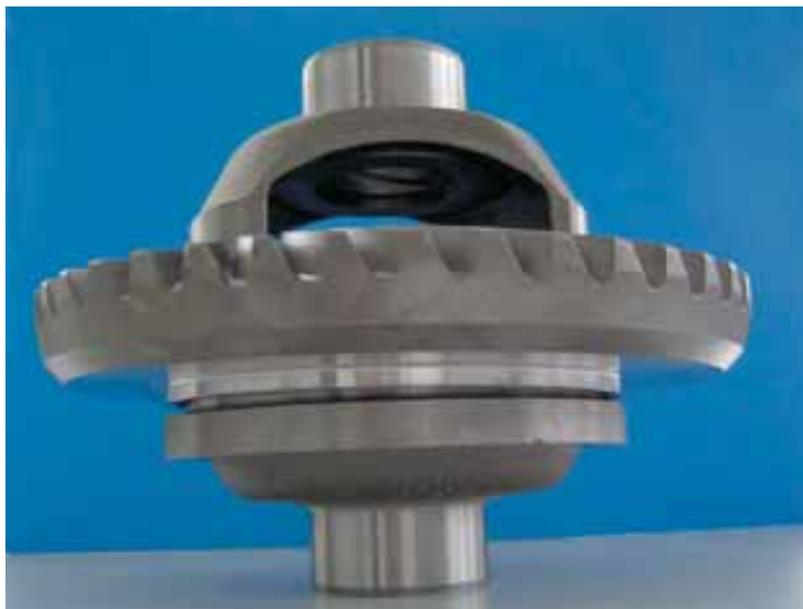
Abb. 68: Differentialgehäuse aus Grauguss und Einsatzstahl.
