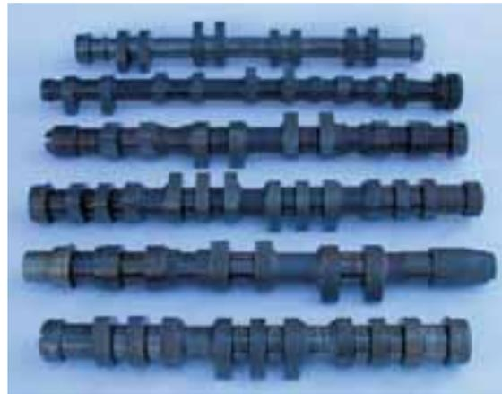
Abb. 33 und 34: Verschiedene Nockenwellen mit 6 bis 12 Nocken.
