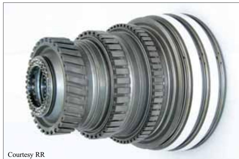
*Abb. 151, 152: Blisks (bladed disks) sind Bauteile der höchsten Sicherheitsklasse. Sie werden aus zwei unterschiedlichen Titanlegierungen gefertigt und in der Hochdruckstufe des Kompressors eingesetzt. Die Schaufeln sind integraler Bestandteil der Scheiben, die über Umfangsnähte zur Rotortrommel verschweißt werden.*
