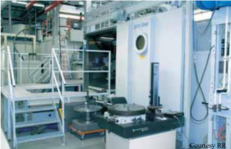
*Abb. 148: 10 m<sup>3</sup> EB Anlage zum Schweißen von Triebwerkskomponenten voll CNC gesteuert.*
