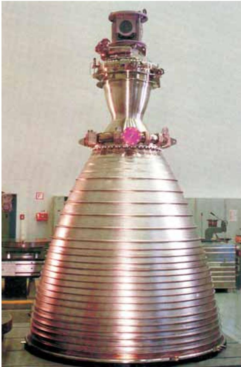
Das Einspritzsystem für die Hauptstufe, der sogenannte LOX-Dom wird mit 3 Elektronenstrahlnähten gefügt, an die höchste Qualitätsanforderungen gestellt werden.
