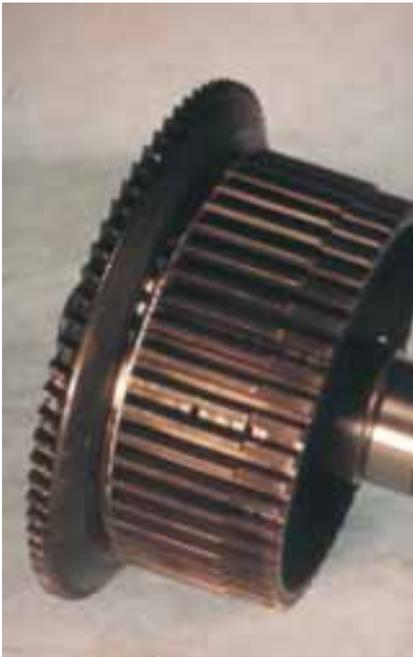
*Abb. 113: Gesinterte Kuppelstrommel an umgeformte Zahnscheibe und Welle geschweißt.*
