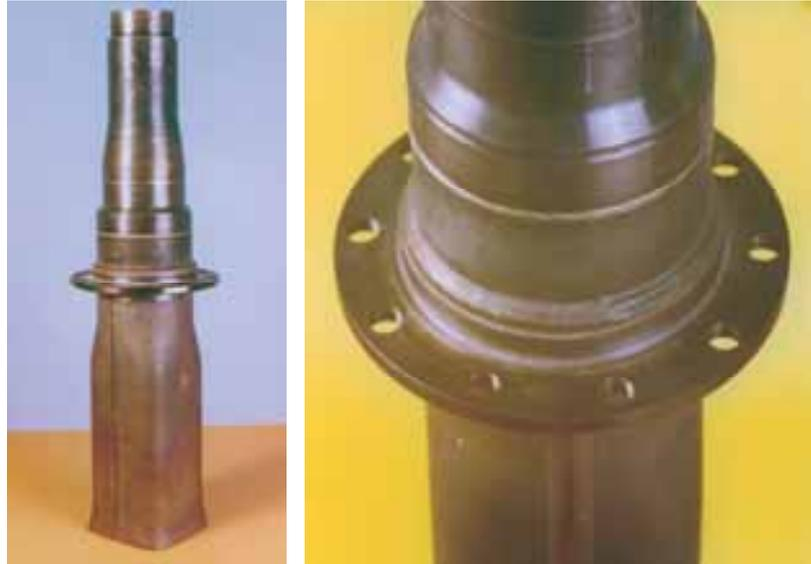
*Abb. 73, 74: Ein Achsstummel einer LKW-Achse wird mit der oberen Schweißnaht an die Achse geschweißt. Der Bremsflansch wird mit mehreren nebeneinander liegenden Schweißnähten an der Achse befestigt, um den tragenden Querschnitt zu vergrößern.*
