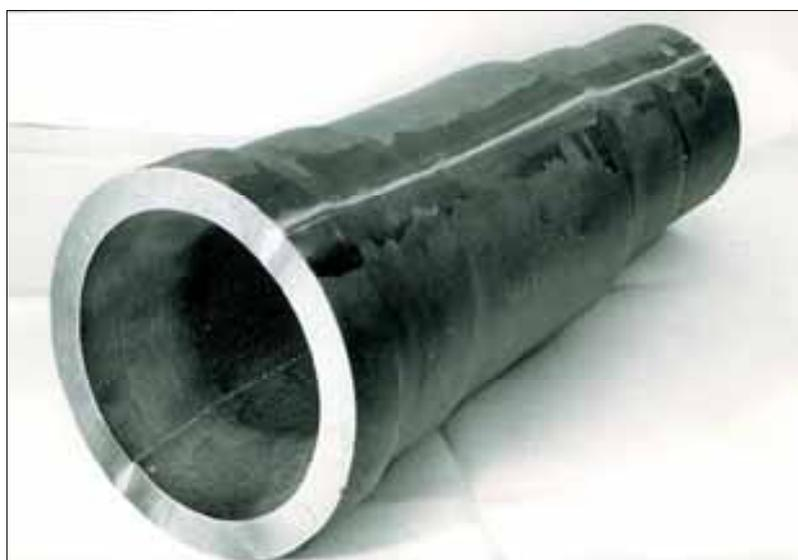
Abb. 71: Zwei Halbschalen einer Achse (Probestück für Schweißversuche).
