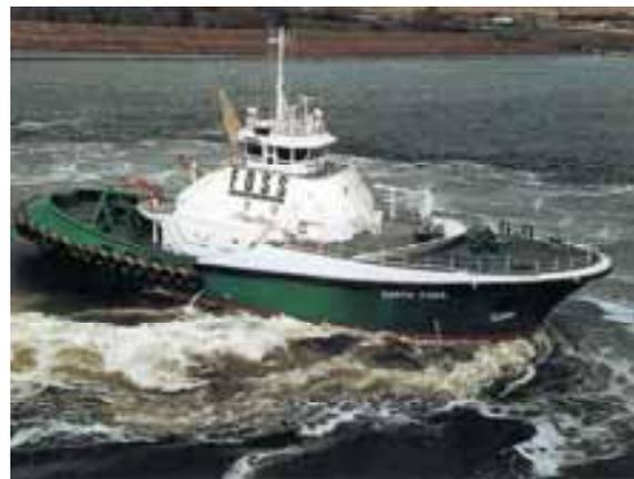
Abb. 225: Ein Hightech-Antriebssystem für Schlepper mit verstellbarem Vorschub in Kraft und Richtung erlaubt es, das Boot auf der Stelle zu drehen.
