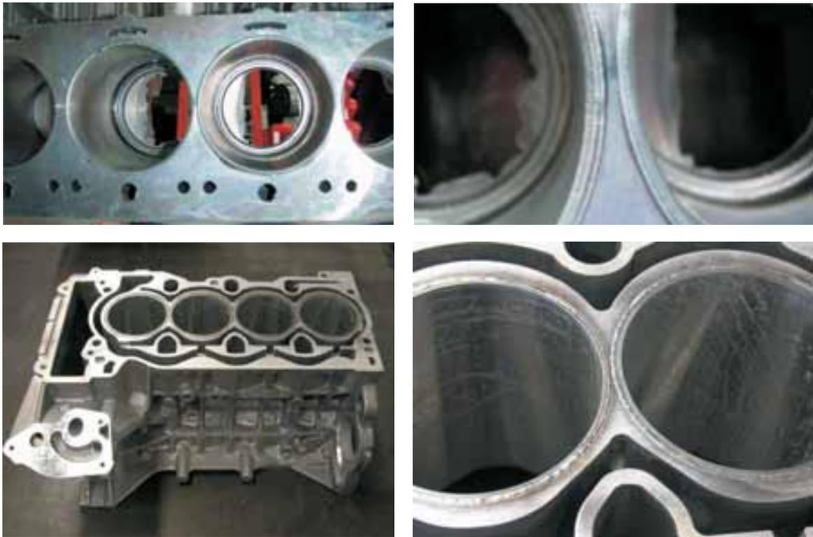
Abb. 19, 20, 21, 22: Motorblöcke mit eingesetzten Laufbuchsen, „closed deck“ (oben) und „open deck“ (unten).
