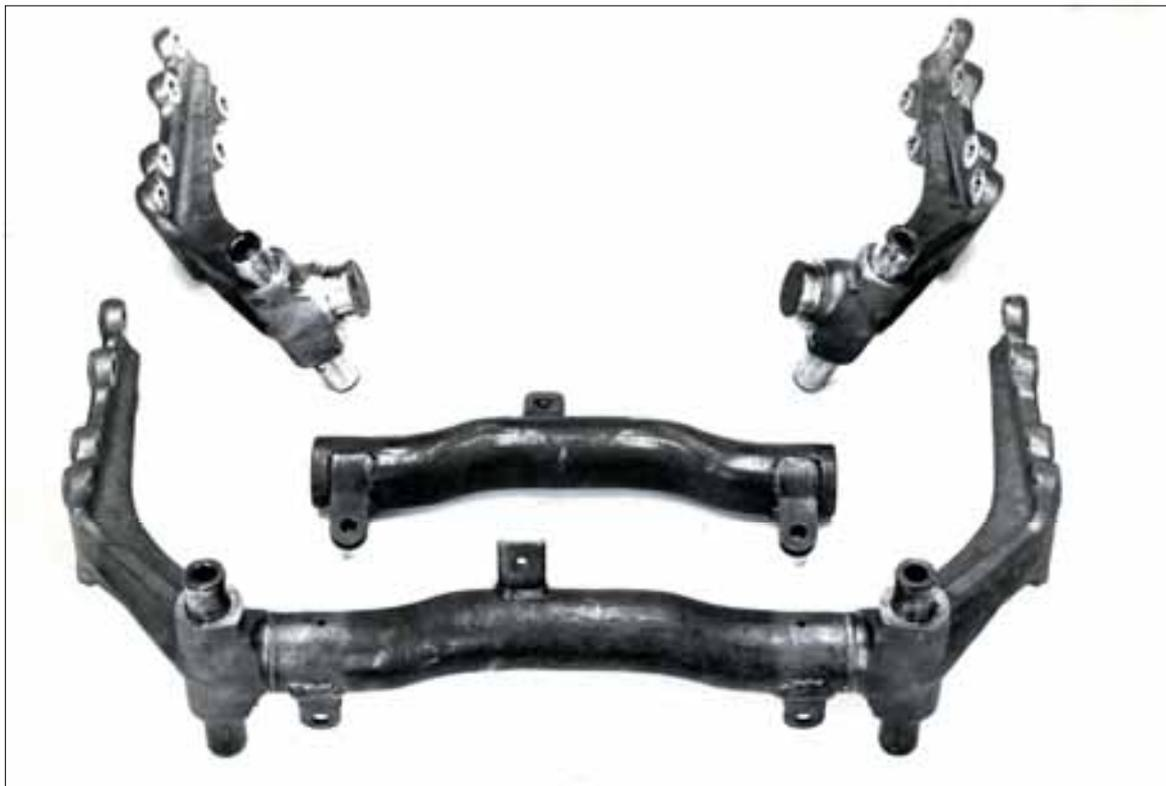
*Abb. 75: SUV-Achse aus zwei Schmiedeteilen und einem umgeformten Rohr hergestellt.*
