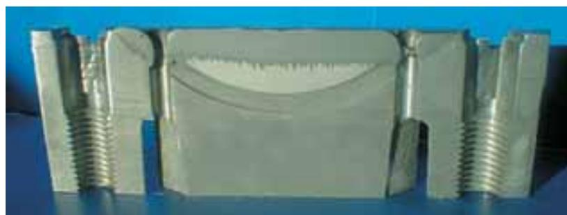
*Abb. 12, 13, 14: In den Steg zwischen 2 Laufbuchsen wird ein Schlitz gefräst und mit einem Formblech verschlossen, das mit 2 EB-Nähten abgedichtet wird. Längs- und Querschliff durch den Kühlwasserschlit.*
