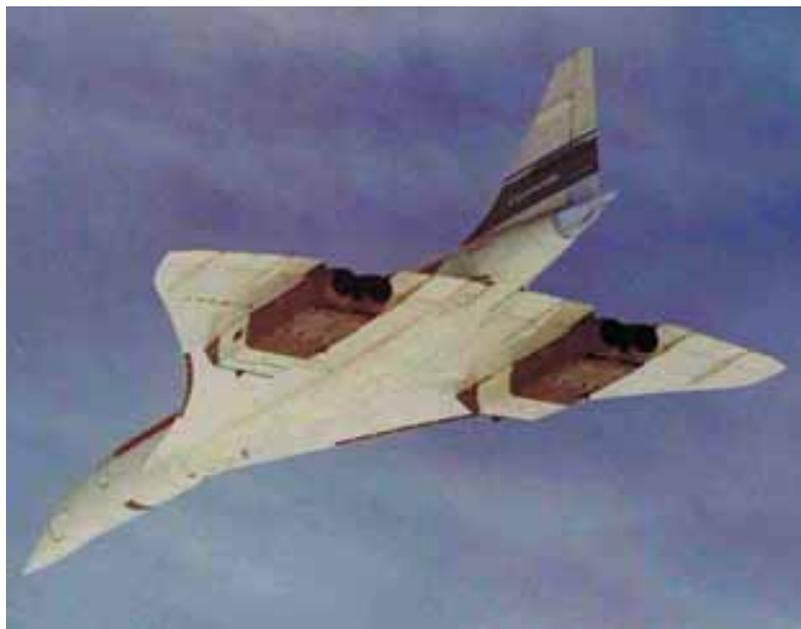
*Abb. 140: Überschallflugzeug Concorde mit den EB-geschweißten Triebwerksverkleidungen.*
