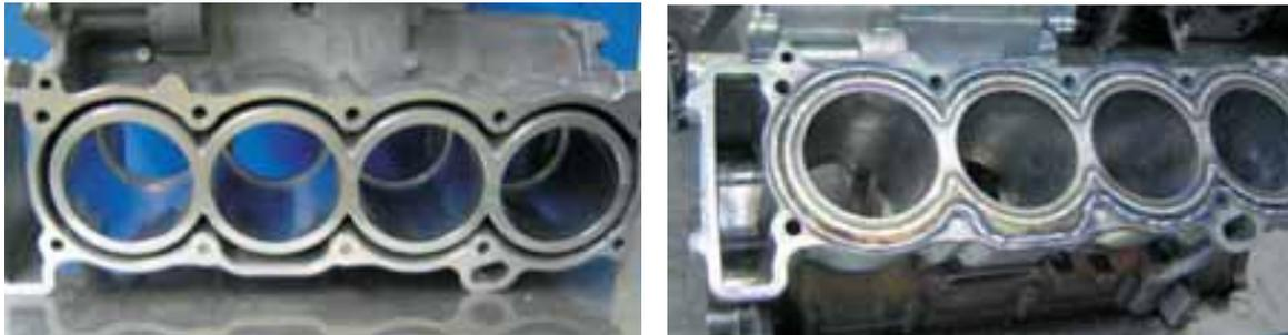
Abb. 17, 18: Kurbelgehäuse als „closed deck“ Konstruktion, links offen, rechts verschweißt.
