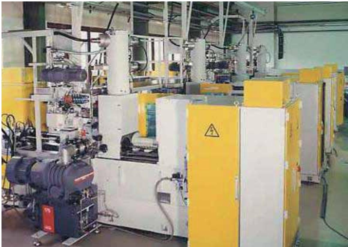
Abb. 35: Doppelkammermaschinen zur Randschichtbehandlung von Nocken.
