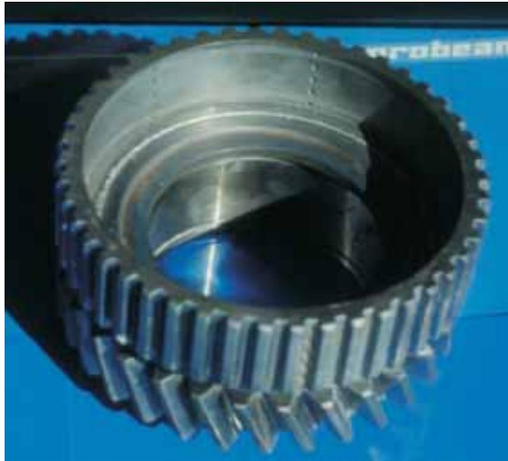
*Abb. 114: Fügen von geschmiedeten und zerspannten Zahnkörpern.*
