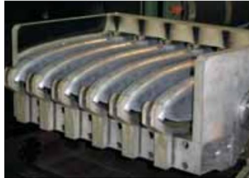
*Abb. 144: Mehrfachvorrichtung zum Schweißen der Armlehnen von vier Seiten.*
