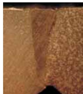
Abb. 69, 70: Der Lösungsansatz mit geringer Einschweißtiefe ohne Zusatzwerkstoff und mit Einsatzschicht ist erfolgreich.
