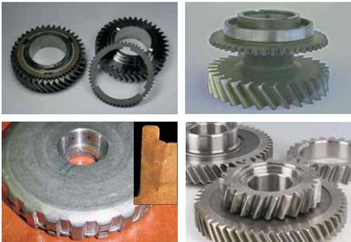
Abb. 107, 108, 109, 110: Eine Auswahl von Zahnradkombinationen für Autogetriebe.
