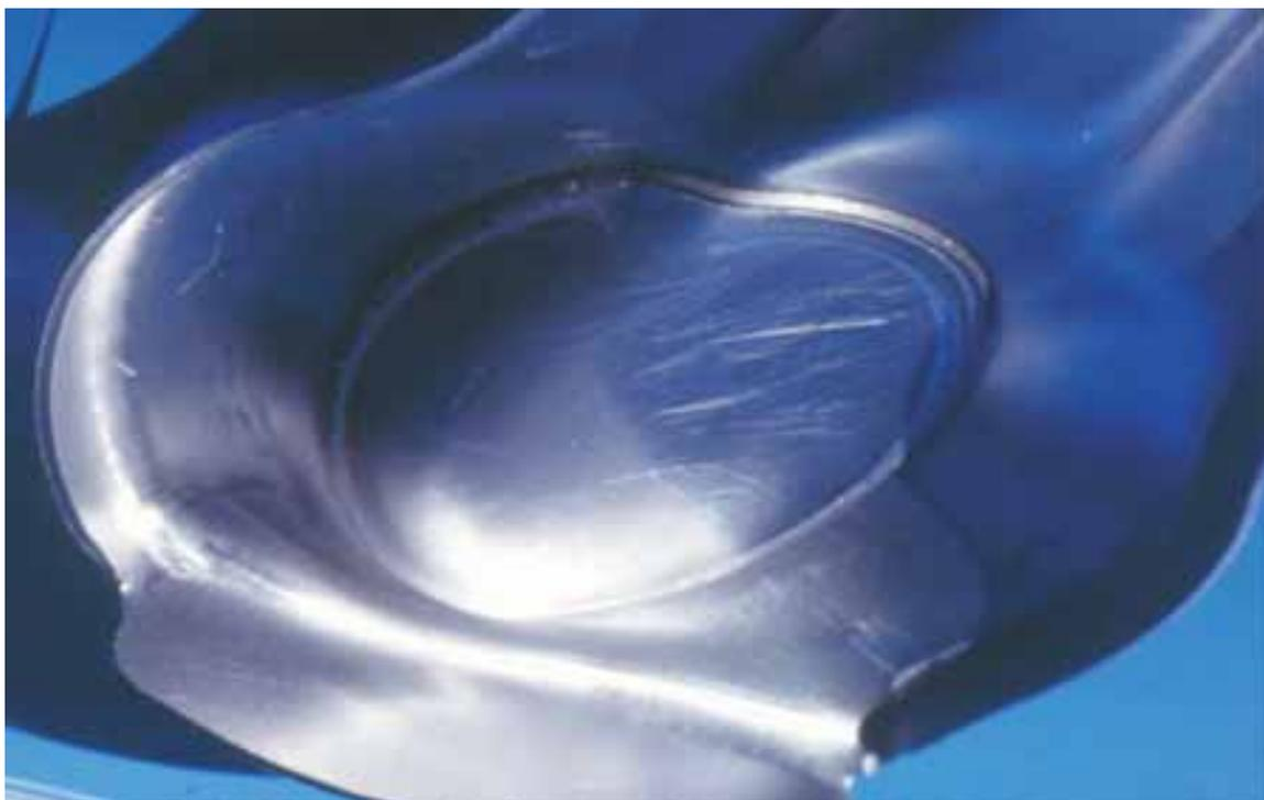
*Abb. 101: Tailored blank als Auflage für den Stoßdämpfer. Eine 2 mm dicke Scheibe wird in das 1 mm dicke Blech für den Radkasten eingeschweißt und anschließend umgeformt.*
