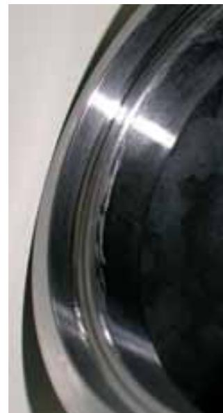
*Abb. 85: Schweißwurzel am Stützring.*
