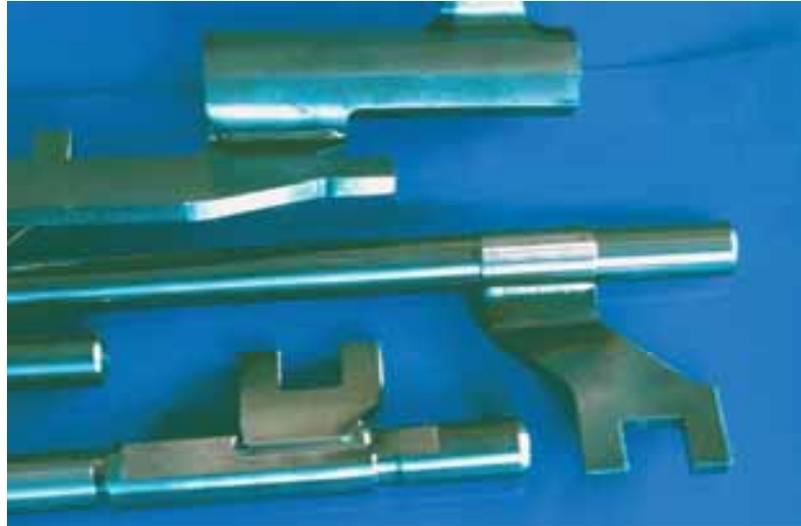
*Abb. 87: Schaltgestänge.*
