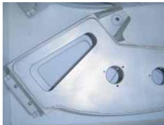
*Abb. 146, 147: Tragarm mit Schweißvorrichtung und geschweißter Kantenkontur.*
