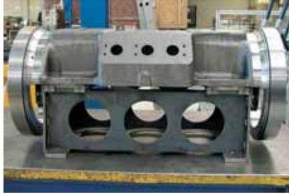
*Abb. 195: Hohlwellenlager werden an den gegossenen Achskörper geschweißt.*
