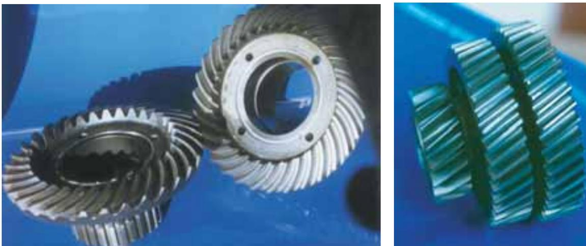
Abb. 111, 112: Kegelräder und Dreifachverzahnungen werden vorteilhaft gefertigt, indem die Bauteile einzeln zerspanend bearbeitet werden. Das anschließende Fügeverfahren erfordert einen Prozess mit geringer Wärmeeinbringung, da die Teile häufig schon gehärtet sind und nur geringster Verzug zulässig ist, um die spezifizierten Toleranzen einzuhalten.
