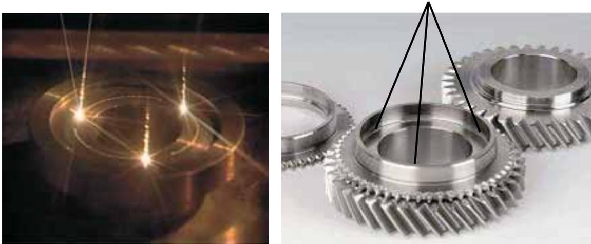
Abb. 103, 104: Drei Schweißstrahlen mit um  $120^\circ$  versetzter symmetrischer Wärmeeinbringung verhindern Achsversatz.
