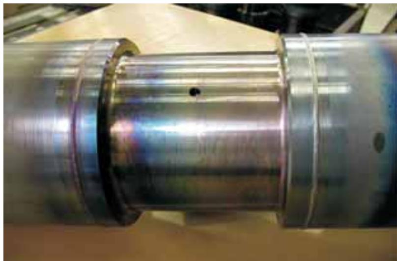
Die Konstruktion einer flexiblen Kupplung sieht das Fügen von Federplatten durch EB-Schweißen vor, wodurch ein torsionssteifes, flexibles Kupplungselement entsteht. Es gleicht zulässige Toleranzen zwischen dem Motor und dem Antriebssystem aus, während die Zwischenwelle in allen Richtungen steif ist.
