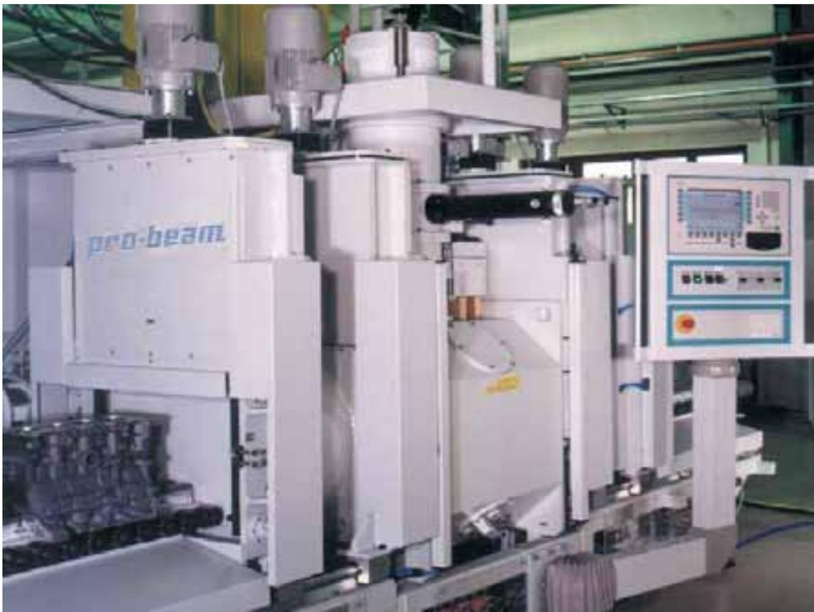
*Abb. 16: Schleusen-Transfermaschine zum Elektronenstrahlschweißen von 4-Zylinder Kurbelgehäusen.*
