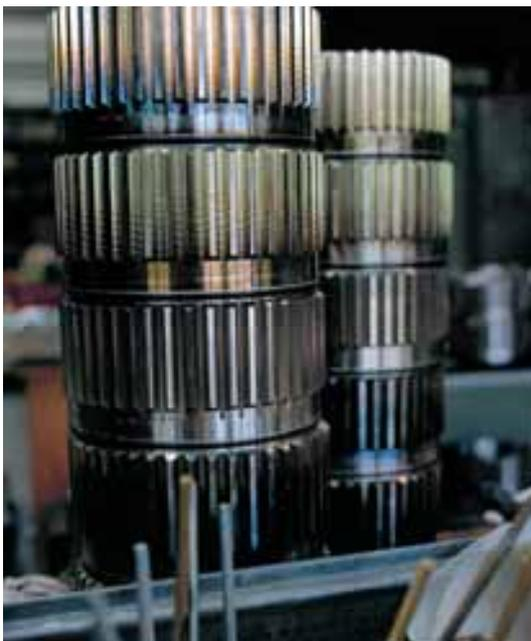
*Abb. 115: Radiale EB-Schweißnähte zwischen Flanschen und Zahnkörpern.*
